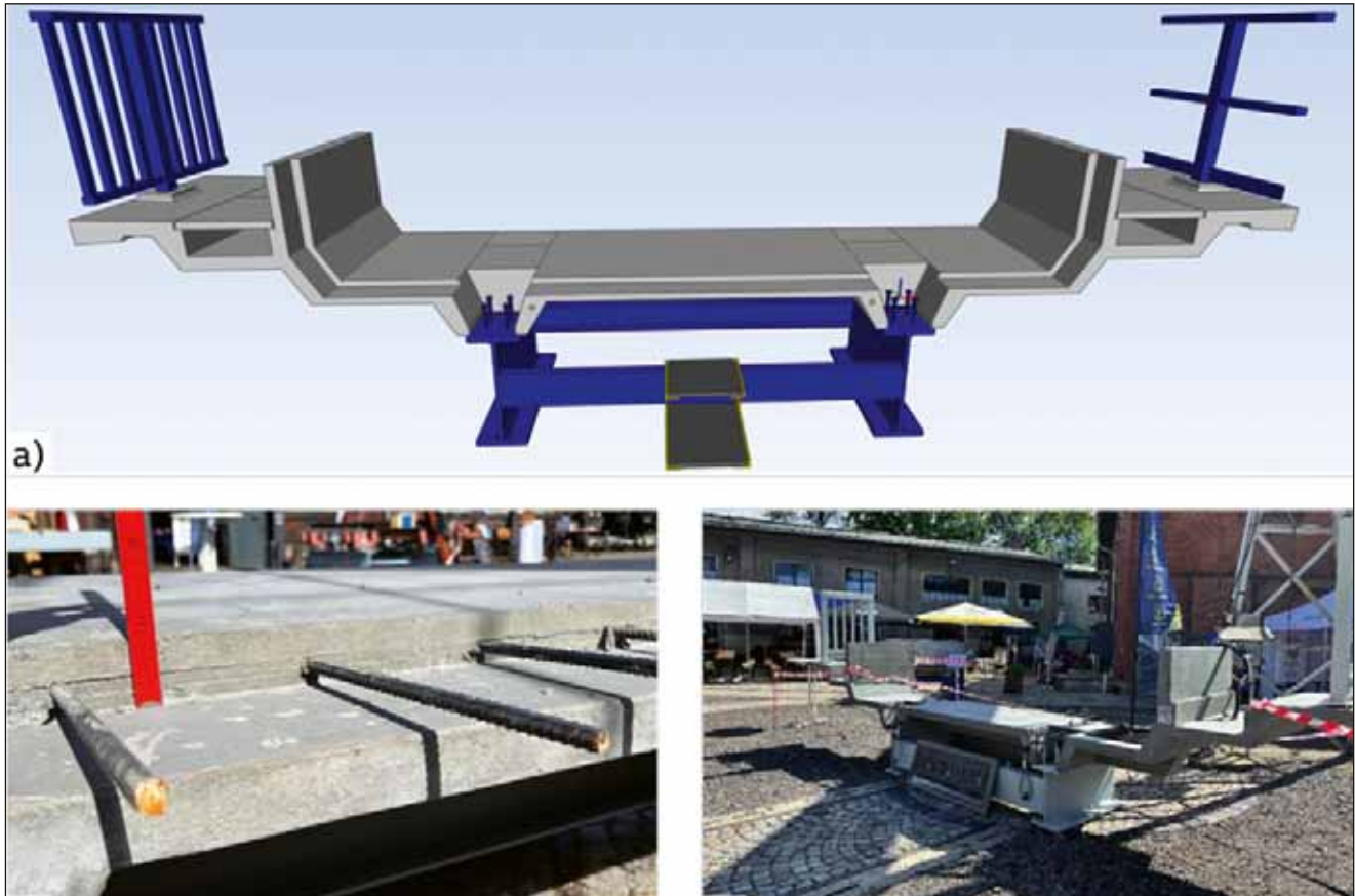
Abbildung 5: a) 3D-Modell des UHFB-Musterbauteils und Auszug aus dem Bewehrungsplan [Quelle: MKP] b) und c) Ausstellung des Musterbauteils bei den Chemnitzer Eisenbahntagen 2024 sowie Detail mit 8cm Querschnitt. [Fotos: Pelka]
