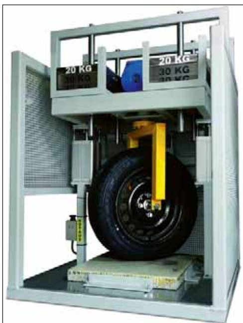
Bild 2: Versuchsstand für den PAT-Test der Sika Deutschland CH AG & Co KG (links), Rundlaufprüfanlage der BAST (rechts)
