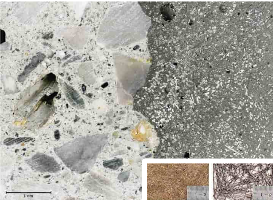
UHFB-Premix: Feststoff mit Kurzfasern vor Zugabe von Wasser und Fließmittel (Foto: MKP/Kottmeier)
