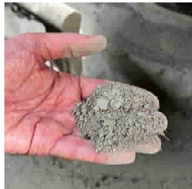
UHFB-Premix: Feststoff mit Kurzfasern vor Zugabe von Wasser und Fließmittel (Foto: MKP/Kottmeier)
